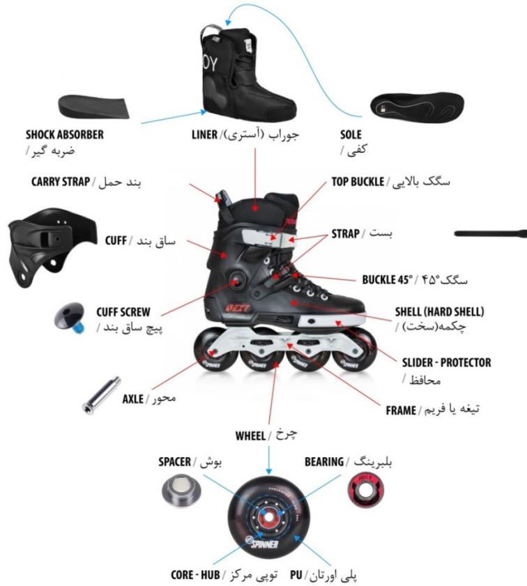
شکل ۱ اجزاء یک کفش اسکیت
